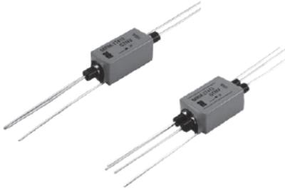
ハイブリッド自動車のハイブリッドシステムの動作電圧はおよそ600Vに達することがありますが、その際の電力変換インバーター用のパワーデバイスに要求される耐圧は約1.2KV~2.6KVになります。本シリーズは、この耐電圧測定を可能にしました。絶縁耐圧は各導体間3500Vの特性を備え、絶縁抵抗は $10^{13}\Omega$ 以上と微小漏れ電流検知にも使用できます。
